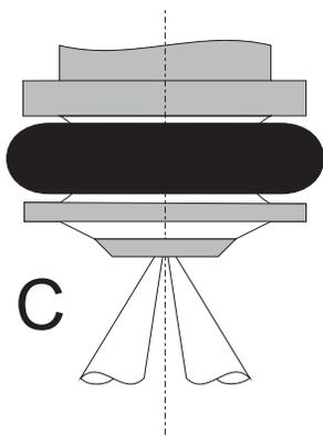
La figura C muestra la tercera de las formas de **cono de aspersión** por chorro doble que salen de la tobera por los orificios dispuestos de tal forma que proyectan dos chorros de combustible, compuestos por varios chorros individuales que van a morir delante de las válvulas de admisión o sobre las bases de separación de estas. Se usa generalmente en cilindros con dos válvulas de admisión, pero es absolutamente necesario en cilindros con tres válvulas de admisión.
